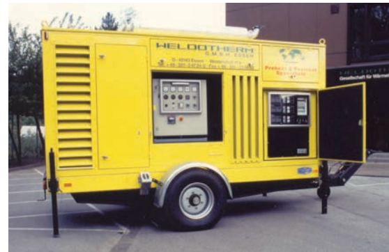
Автономная нагревательная установка с дизельным генератором на автомобильном шасси. Мощность генератора: 130 кВт. Мощность установки: 120 кВт Максимальная скорость – 80 км/ч. Применение: Подогрев газонаполненных трубопроводов в полевых условиях
