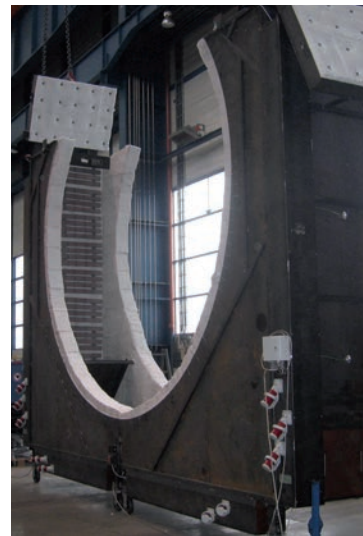
2-х секционная конструкция для проведения термообработки ёмкости с ролганга
