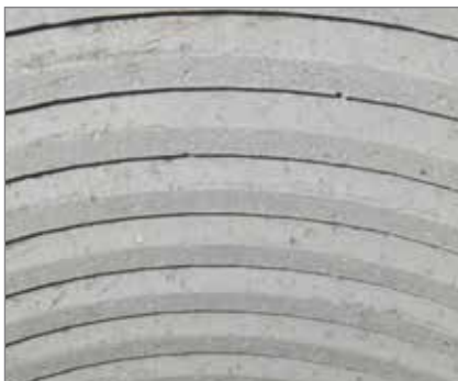
Topné spirály v drážkách žárobetonových tvarovek / Heating coils deposited in refractory castable shapes / Нагревательные спирали в углублениях жаростойкого бетона
