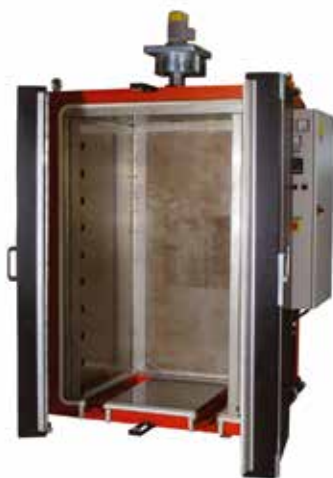
SV pro druhou část linky – umělé stárnutí / SV for the second part of the line – artificial aging / SV для второй части линии - искусственное старение
