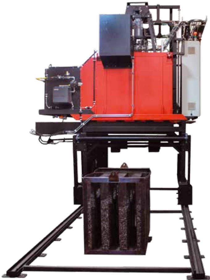
Atypická kalicí plynová linka KNC/VP 1800/65 + KLV 8000 se vsázkovým košem / Atypical hardening gas-fired line KNC/VP 1800/65 + KLV 8000 with charge basket / Нестандартная газовая закалочная линия KNC/VP 1800/65 + KLV 8000 с корзиной для садки
