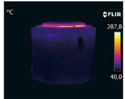
Termografická analýza teploty pláště / Thermographic analysis of furnace jacket temperature / Термографический анализ температуры кожуха
