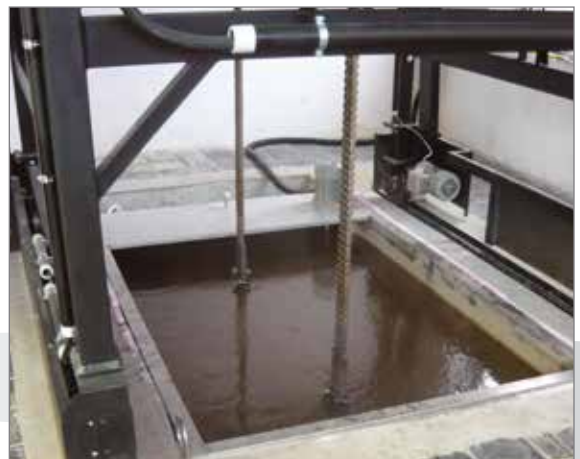
Detail kalicí lázně KLV 4000 / Detail of quenching bath KLV 4000 / Закалочная ванная KLV 4000
