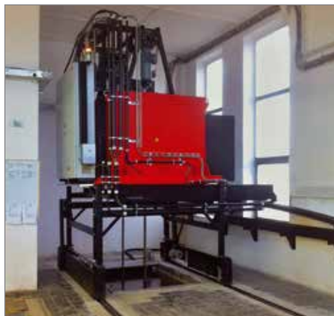
Kalicí linka KNCV 1800 + KLV 4000 / Hardening line KNCV 1800 + KLV 4000 / Закалочная линия KNCV 1800 + KLV 4000
