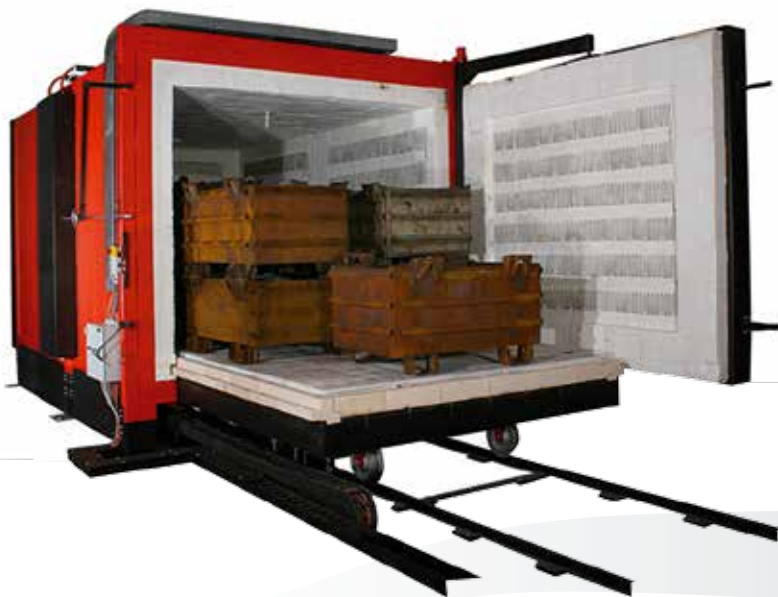
Atyp VKT 18500 se vsázkou na vozu (provedení s dveřmi na „C“ závěsu) / Atypical VKT 18500 with charge on the bogie (door on C-type hinges) / Нетипичный VKT 18500 с шихтой на тележке (исполнение с дверями на „С“ петле)
