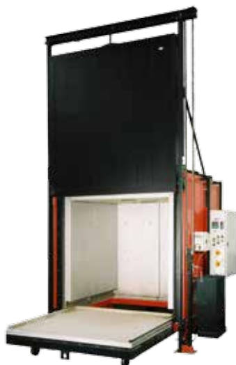
Atyp SVK 3600 (otevírání dveří nahoru) / Atypical SVK 3600 (door opening upwards) / Нетипичный SVK 3600 (открывание дверей вверх)
