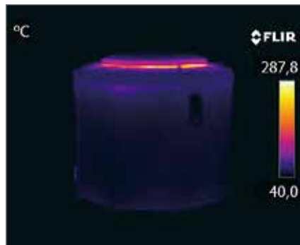
Termografická analýza teploty pláště / Thermographic analysis of furnace jacket temperature / Термографический анализ температуры кожуха
